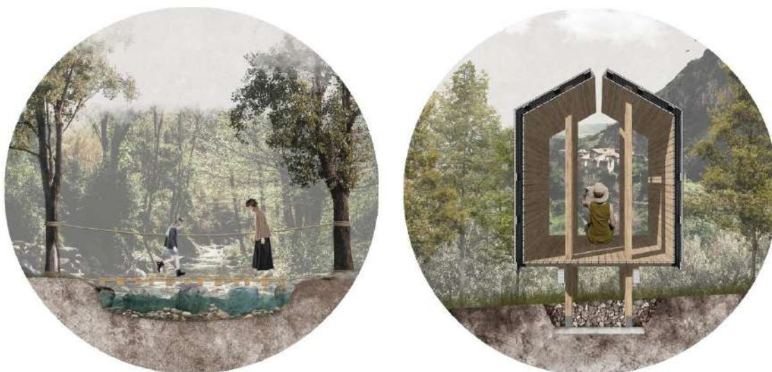
Figure 2 e 3: Ponte removibile in legno realizzato con connessioni a secco - Viewpoint temporaneo. Autore Cristian Murace
