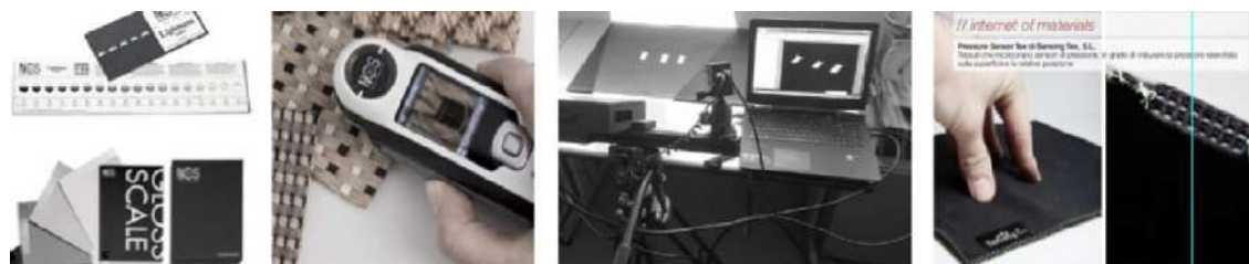
Fig. 4: Strumenti della Material Library per la misurazione delle variazioni sensoriali : sensori di pressione "pressure sensor tex" per i valori di morbidezza e scanner ottici 3D per la rugosità.
